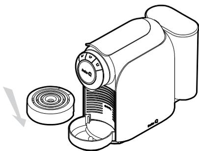
Fig. 13: Baixe a bandeja para apoio de chávenas.
